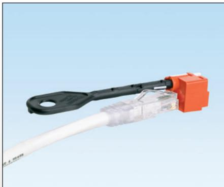
**Para instalar el dispositivo al plug:** Inserte la herramienta y gire 90° en el sentido del reloj. Inserte el Plug en el dispositivo. Gire volviendo a la posición inicial y retire.
