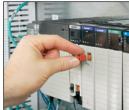
Dispositivo para Bloqueo de USB, tipo B (PSL-USBB y PSL-PERM-USBB)
