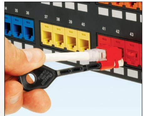
**Para retirar el plug del conector:** Inserte la herramienta al dispositivo y gire 180° en el sentido del reloj. Gire para devolver la herramienta a su posición original y retirela del dispositivo.
